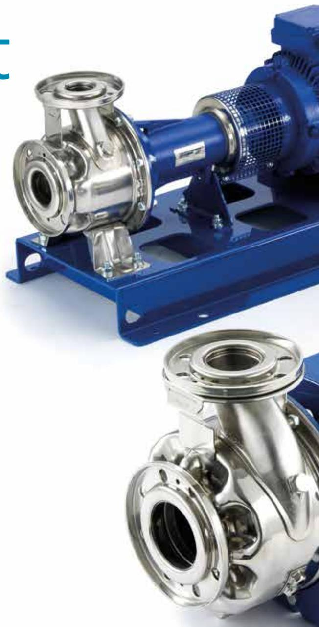
La série e-SH de Lowara est une pompe centrifuge monobloc fabriquée en acier inoxydable AISI 316 et conçue afin de faciliter l'extraction de la roue et du moteur sans démontage de la volute. Le rendement hydraulique a été amélioré avec un indice MEI supérieur aux exigences de la directive ErP 2015. La consommation énergétique a diminué grâce aux moteurs IE3 disponibles en standard sur toutes les tailles.
