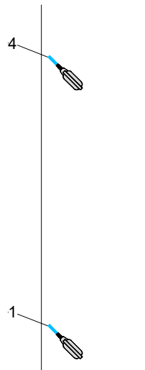
Abb. Ein-Pumpensteuerung mit einem Schwimmerschalter
