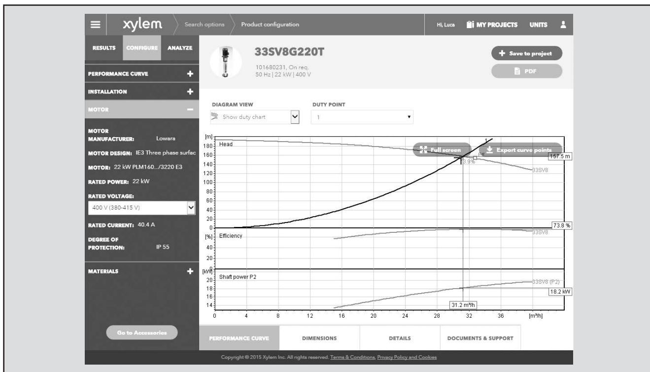
Die detaillierte Anzeige erleichtert die Auswahl der optimalen Pumpe aus den vorgeschlagenen Alternativen.
